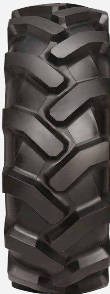
**Dimensiones Estáticas +/-2%**Ancho de Sección **622** mmDiámetro Total **1831** mmRadio de Carga Dinámica **831** mm**Dimensiones Dinámicas +/-2%**Circunferencia de Rodadura **5454** mmRadio de Carga Dinámica **872** mm**Llantas**Llantas Recomendadas **DH21**
