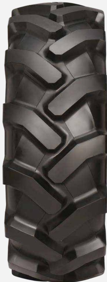
**Dimensiones Estáticas +/-2%**Ancho de Sección **605** mmDiámetro Total **1491** mmRadio de Carga Dinámica **677** mm**Dimensiones Dinámicas +/-2%**Circunferencia de Rodadura **4490** mmRadio de Carga Dinámica **710** mm**Llantas**Llantas Recomendadas **DW18**
