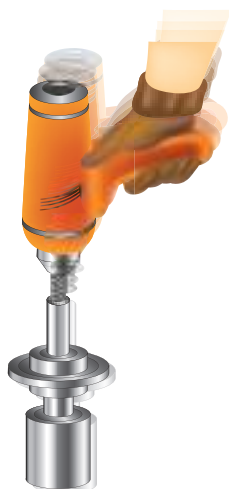
Rosca dañada por uso de pistola neumática
